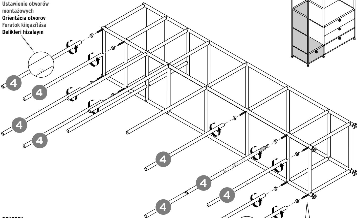
**DEUTSCH**Drehen Sie die Stangen **4** handfest an, aber nicht darüber hinaus!Wenn die Bohrungen nicht richtig ausgerichtet sind, drehen Sie die Stangen **4** etwas zurück. Auch wenn sie jetzt etwas locker sitzen, werden sie durch den weiteren Aufbau ausreichend stabilisiert.**FRANÇAIS**Vissez les barres **4** à la main, mais sans trop serrer! Si les trous ne sont pas bien orientés, dévissez un peu les barres **4**.
